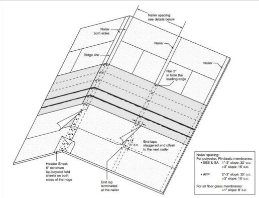
☐ En techos inclinados las membranas se instalan según muestra la imagen. Verticalmente. No horizontal.
