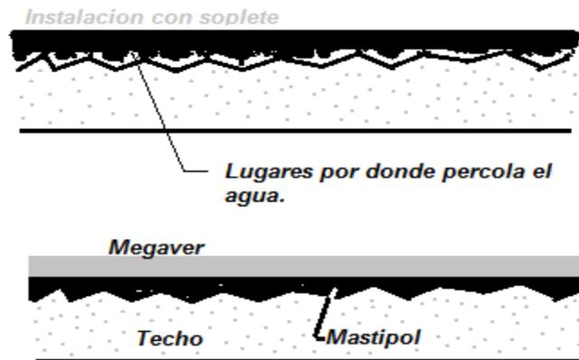
Con Adheso la adherencia es total. No existe riesgo de quedarse áreas sin adherir como pasa cuando se queman las membranas en el techo con soplete. No existe percolación. Su vida promedio se incrementa.
